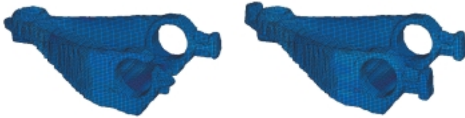
Bild 9: Formfüllung des Bauteils Achsschenkel ,Legierung AlSi7Mg, Rohteilgeometrie \varnothing 65 mm x 62,5 mm;; Rohteiltemperatur 580°C; Werkzeugtemperatur 300°C; Stößelgeschwindigkeit 400 mm/s, der Farbverlauf zeigt die Viskositätsverteilung.
