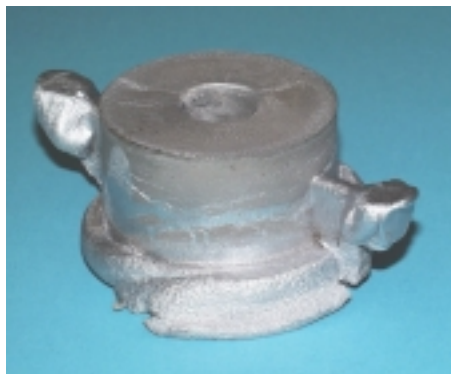
Bild 7: Formfüllung des Napfbauteils mit Schlitz beim simulierten Umformweg
